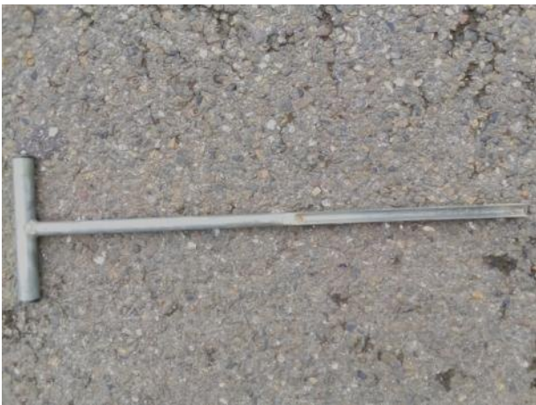
Photo : tarière pour prélever sur 30 cm de sol et observer le taux d'humidité
